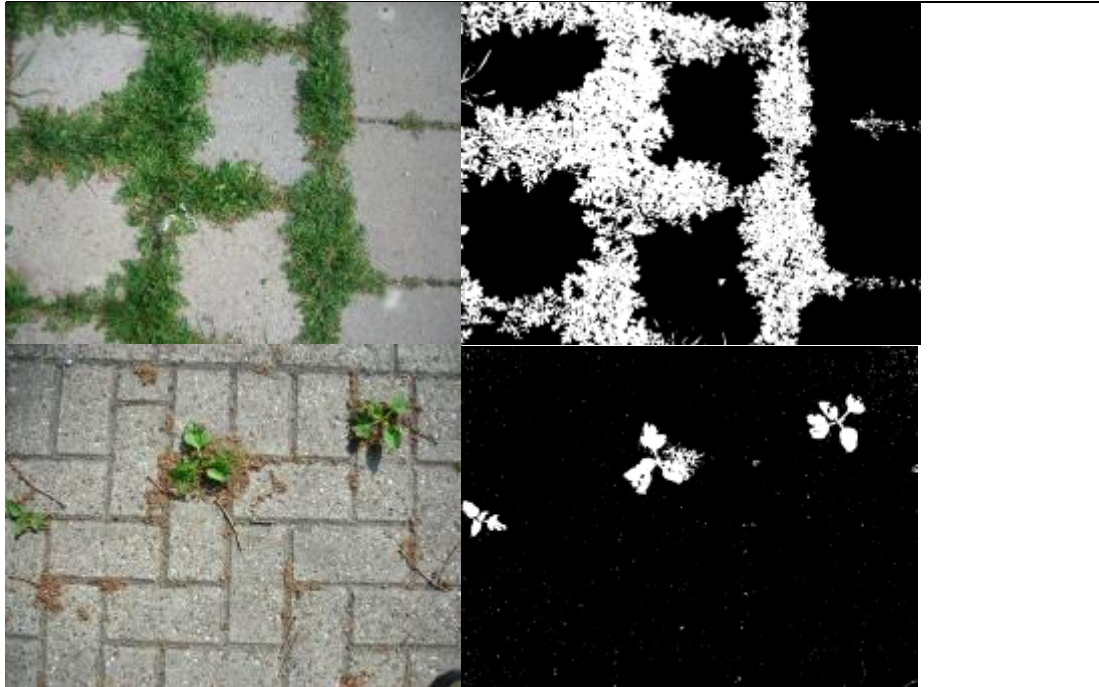
Figuur 23 Twee voorbeelden van beeldanalyse, de berekende onkruidbedekking is 34,9% (boven) en 2,8% (onder)
