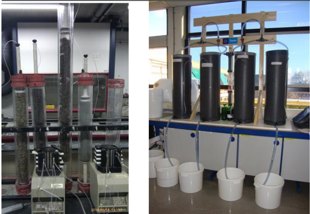
Figuur 1 Links: traditionele kolomproefopstelling voor bepalen zuiverend rendement. Rechts: Speciaal ontworpen kolomproefopstelling voor hoge debieten
