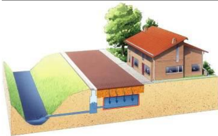
Figuur 14 Werking doorlatende verharding
